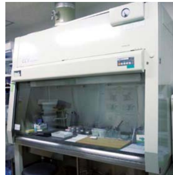
●図2 ドラフターベンチ 感染防止やホルマリン曝露防止のためドラフターベンチ内で検体を取扱っています。
