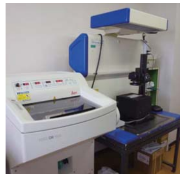
●図3 クライオスタット(左)とオープン型ドラフター(右) 手術中の迅速病理検査では組織を急速凍結し固まらせ、マイナス20℃のクライオスタット(写真左)で薄切します。 検体の写真撮影はオープン型ドラフター(写真右)で行われています。
